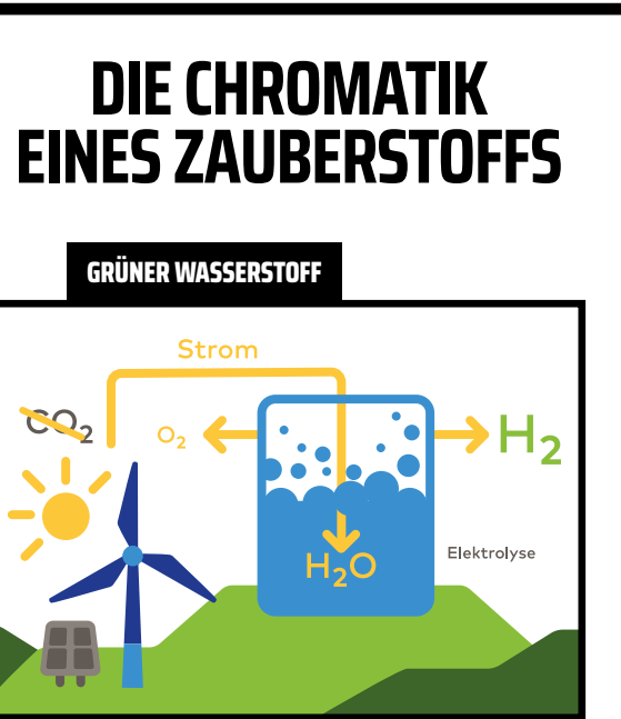
Wasserstoff wird durch Elektrolyse von Wasser mittels grünen Stroms hergestellt, der zumeist aus Wind- und Wasserkraftanlagen oder Photovoltaikparks stammt.
